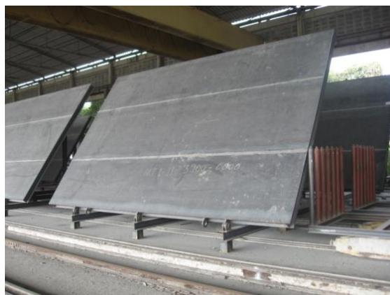
PCM ได้ให้ความสำคัญกับร่องน้ำ โดยได้ลงทุนขยายกำลังผลิตพื้นและผนังคอนกรีตสำเร็จรูปเพื่อประกอบเป็นบ้าน Pre-Cast โดยจะมีกำลังผลิตประมาณ 250,000 ตร.ม. ต่อปี หรือคิดเป็นบ้านสำเร็จรูปประมาณ 500 หลังต่อปี
